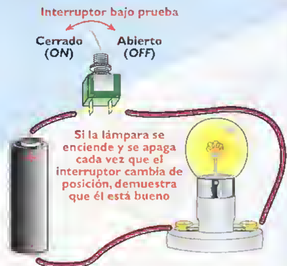
Figura 3.19. Prueba sencilla de un interruptor
